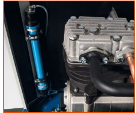
Tubo Control Presión Conexión directa a circuito de aire
