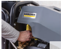
Regulación de caudal en la bomba
