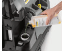
Depósito de descalcificador
