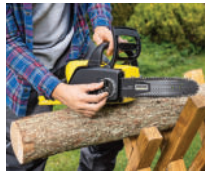
Tensado de la cadena sin herramientas
